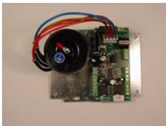
n. 1 Gruppo centralina (piastra con trasformatore 220/20V AC e scheda elettronica)
